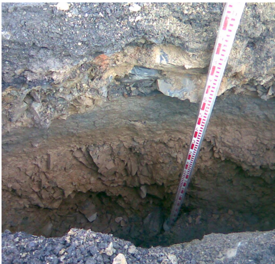
Obr. 10 Kopaná sonda KS-1 a rozpukané břidlice
