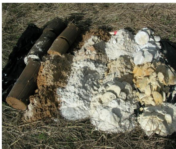
Obr. 8. Vrtné jádro z kaolinických pískovců a vsakovací tunely místně v těchto pískovcích
