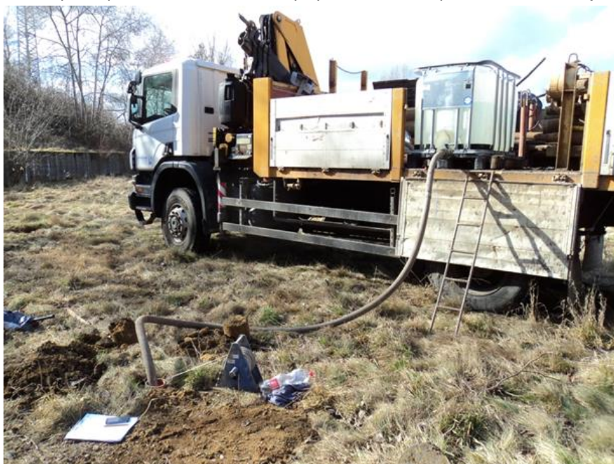
Obr. 1. Realizace vsakovací zkoušky dle ČSN 75 9010
