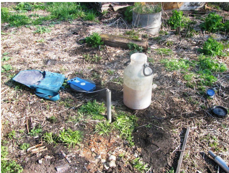
Obr. 2. Realizace vsakovací zkoušky v penetrační sondě
